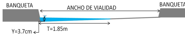
Figura III.8 Sección transversal de la vialidad A1
